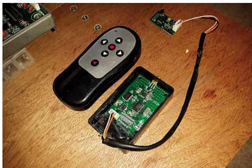
► Der Funkempfänger des Golf-trolleys musste zerlegt werden, damit Marvin die Befehle replizieren konnte, die das Gerät später an den Raspberry Pi senden sollte
