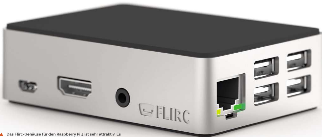
▲ Das Flirc-Gehäuse für den Raspberry Pi 4 ist sehr attraktiv. Es handelt sich um eine Mischung aus Aluminium und Plastik
