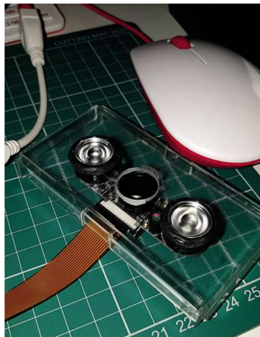
▼ Die ZeroCam und die IR-LEDs sind in Bohrungen montiert und mithilfe von Sugru-Klebstoff fixiert
