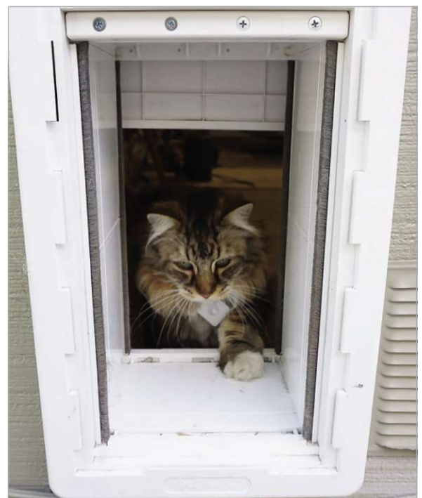
Oben Jede der vier Katzen trägt einen Bluetooth-Tracker-Tag von Tile. Erkennt der Pi einen passenden Tag, öffnet sich die Tür
