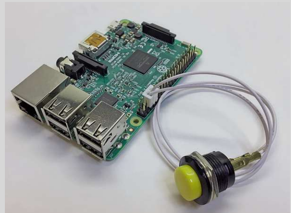
Das Skript ermöglicht es, den Schreibschutz per Jumper oder angeschlossenem Taster zu deaktivieren
