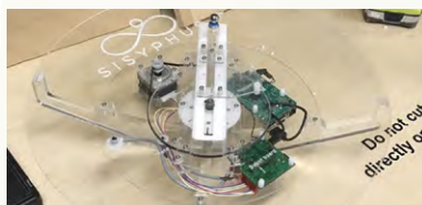
Der Sisbot arbeitet fast wie eine CNC-Fräse und bewegt den Magnet im Kreis und den Arm hoch und runter
