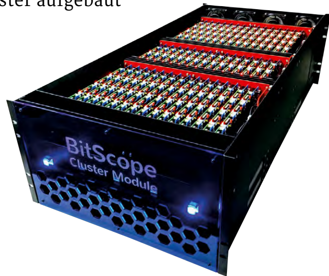
Ein Server-Rack mit 35 Höhen-einheiten und 750 Pi 3 benötigt eine leistungsfähige Stromversorgung und Kühlung
