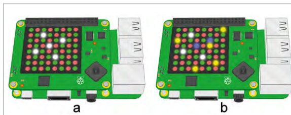
Grafik 4 Das unvollständige Puzzle aus 4a lässt sich lösen, indem man den Cursor auf einer der Damen platziert und den Joystick-Knopf drückt. Die weißen LEDs in 4b stehen schon richtig, die blauen dagegen nicht. Die gelben LEDs zeigen, wo man die Damen für eine Komplettlösung hätte platzieren müssen
