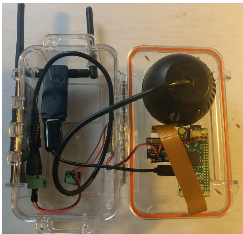
Oben Anordnung und Verbindungen des Kamera-Setups
