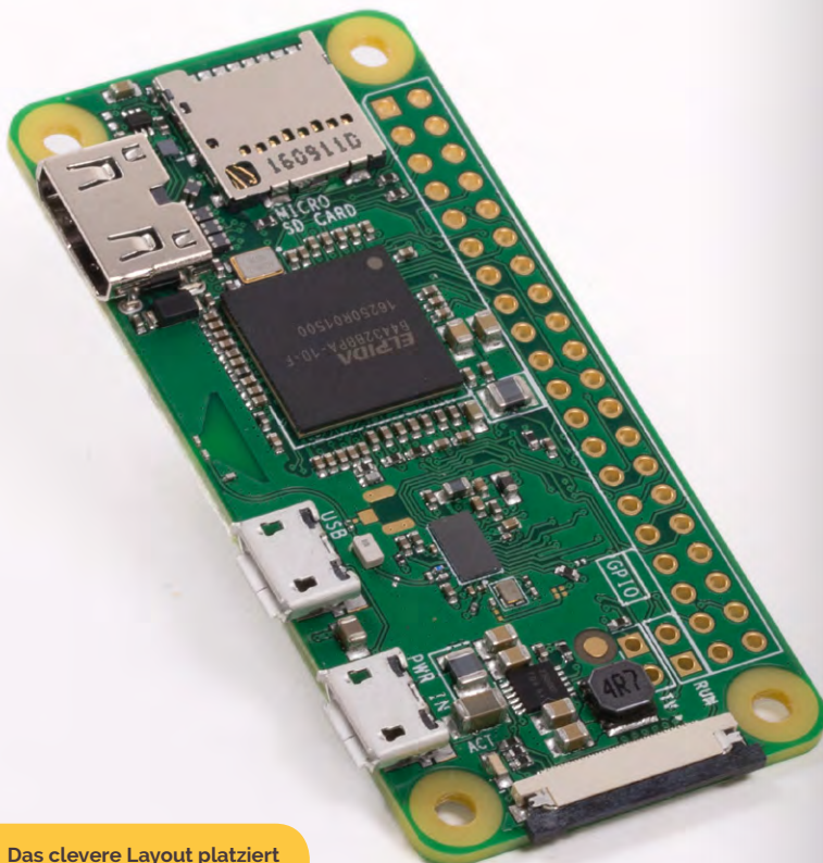
Das clevere Layout platziert sämtliche Schaltkreise auf der Oberseite – das hält die Kosten niedrig.
