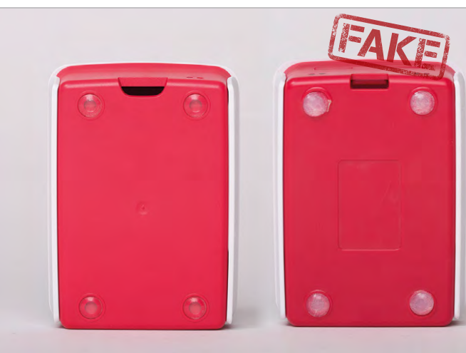
Oben Diese Fälschung hat vier Lichtöffnungen anstatt zwei Unten Die kleinen Gummifüße sind schlecht verklebt
