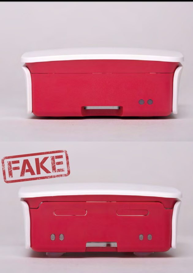
Oben Diese Fälschung hat vier Lichtöffnungen anstatt zwei Unten Die kleinen Gummifüße sind schlecht verklebt
