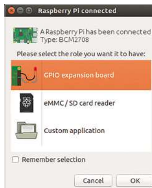
Oben Nach dem Anschluss eines Pi Zero können Sie ihn als GPIO-Erweiterung verwenden
