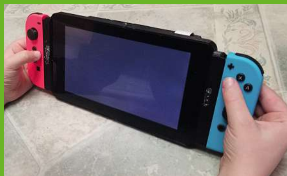
Das Gehäuse wurde an den Seiten so gestaltet, dass die Joy-Cons fest einrasten können
