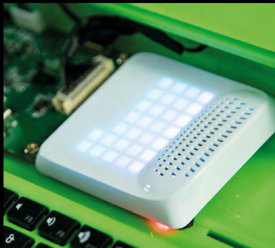
Multimedia-HAT Der Pi-topPULSE bringt neben einer 7 x 7 großen LED-Matrix auch Lautsprecher und Mikrofon mit
