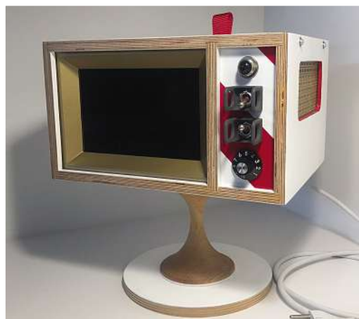
▲ Seitlich sind Belüftungsgitter angebracht. So kann die Wärme auch bei 24-Stunden-Dauerbetrieb sofort entweichen
