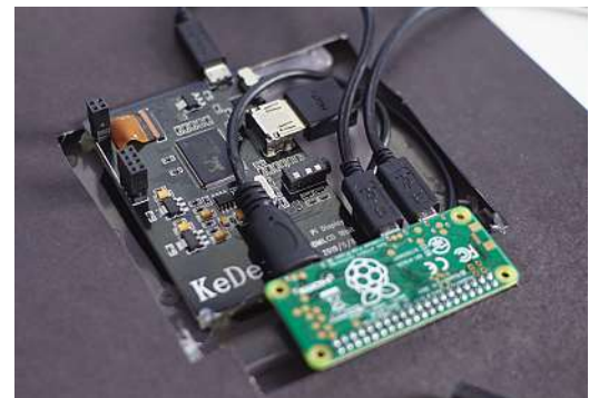
▲ Der Raspberry Pi Zero lässt sich bei Bedarf in ein WLAN einbinden. Das erspart den Datentransfer per USB-Kabel
