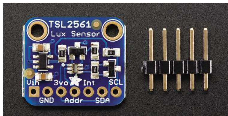
▲ Der TSL2561 misst die Luminanz, also die vorhandene Lichtmenge, und verwendet ebenfalls die I²C-Pins, sodass er sich gemeinsam mit dem BME280-Sensor betreiben lässt
