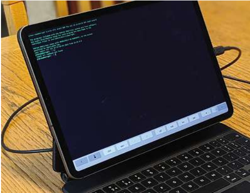
▲ Über die iPad-App Termius steuern Sie den Raspberry Pi via SSH durch Eingaben in die Kommandozeile
