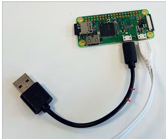
Links Mit einem modifizierten Kabel versorgen Sie den Pi Zero W dauerhaft mit Strom
