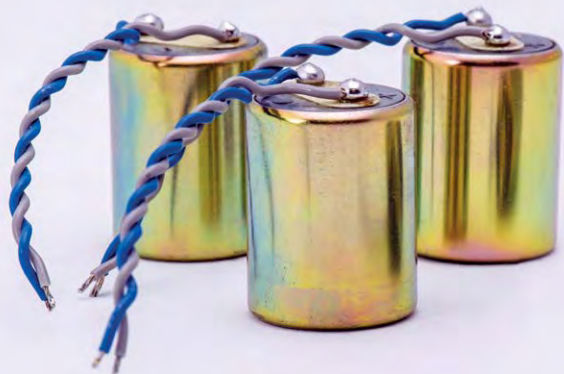
Das Geofon ist ein robuster und doch äußerst empfindlicher Sensor, der selbst auf feinste Erdbewegungen reagiert und Vibrationen akkurat messen kann
